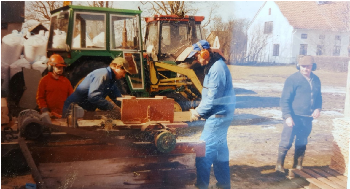
Figur 5 Tibbles spånssåg i bruk av hembygdsföreningen 1992. Spånen är till taket på kvarnen i Hejdeby. Foto: privat
